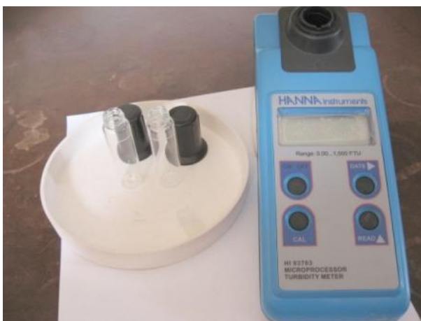
სურ. 2.1.3.2. წყლის სიმღვრივის საზომი HANNA Instruments Turbidimeter
